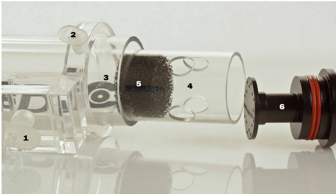
Photo 3: 1. Vis de fixation à la vitre 2. Vis de fixation du tuyau 3. Tuyau extérieur 4. Tuyau intérieur 5. Mousse 6. Fermeture tuyau intérieur (S + M: 2 joints toriques, L: 1 joint torique)
