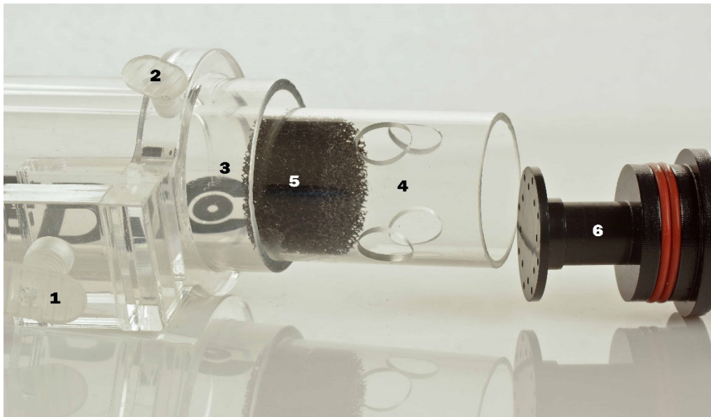
Foto 3: 1. Halteschraube Glasbefestigung 2. Halteschraube Rohrbefestigung 3. Außenrohr 4. Innenrohr 5. Schwamm 6. Verschluss Innenrohr (S + M: 2 O-Ringe, L: 1 O-Ring)
