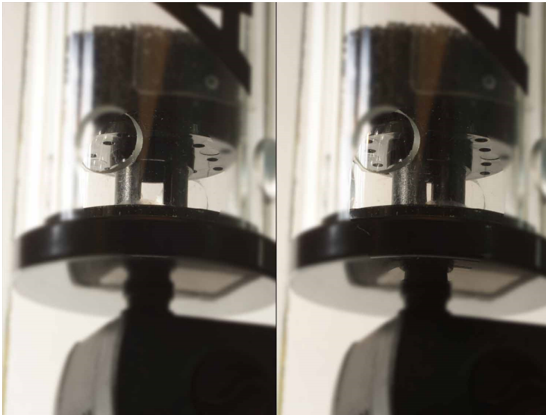
Photo 2: Le réglage du débit s'effectue par modification de la largeur de la fente située dans le réacteur en tournant le bouton ou l'appareil. La pompe est simplement fixée par le bas.
