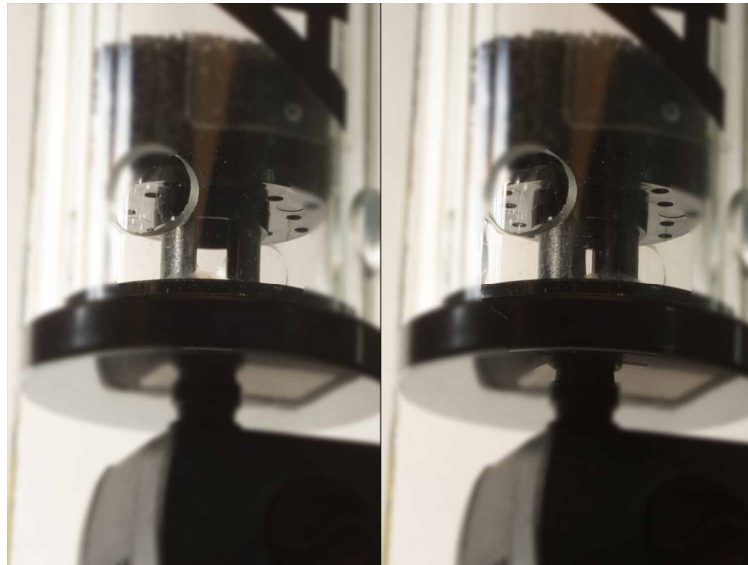
Foto 2: Die Regulierung der Durchflussmenge erfolgt durch Änderung der Spaltbreite im Reaktor, indem man den Knauf oben am Gerät verdreht. Die Pumpe wird von unten einfach aufgesteckt.
